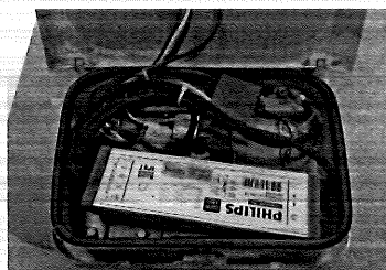
IP6X - Evidência de NÃO Ingresso de pó na amostra.
