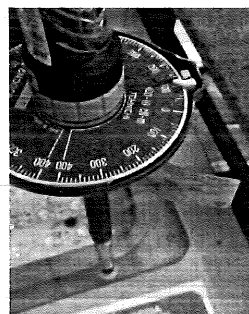
II.A.9.1 - Ensaio do torque nos parafusos
